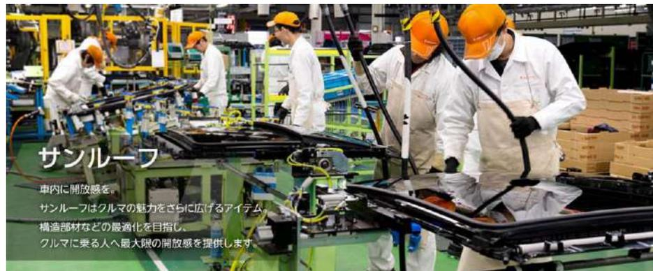
自動車の屋根に窓を設けることで、開放感・爽快感を演出するサンルーフ。柏原工場の製造ラインで組立をしています。
